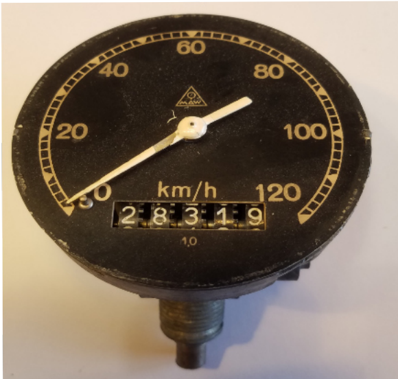
Gehäuseoberteil entfernen und Zeiger mittels Spitzzange abhebeln
