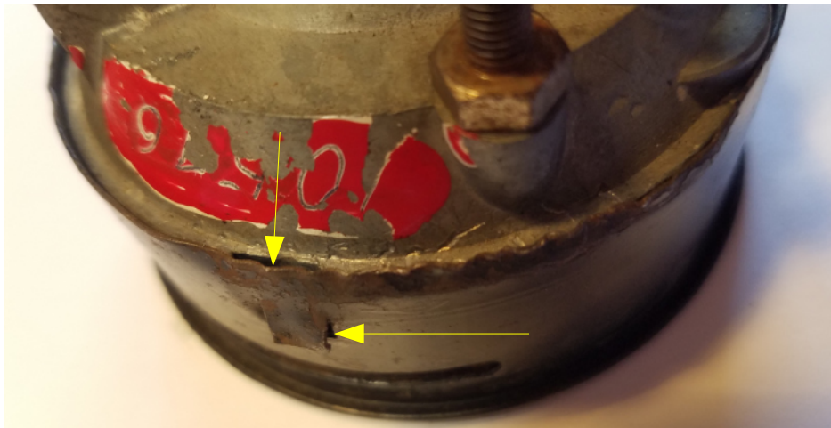
Laschen mittels Schraubenzieher herausbiegen
